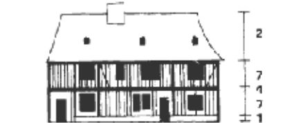
16e siècle : encorbellement marqué, premiers éléments de contreventement obliques
